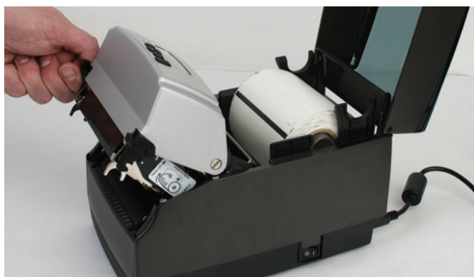
Imagen 2-47. Levante el mecanismo
