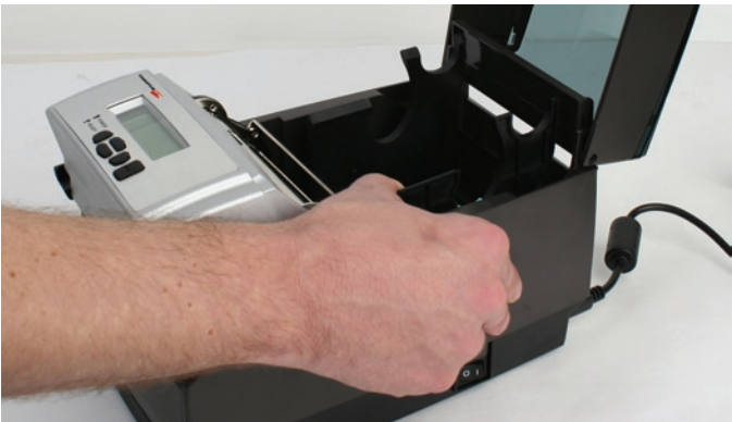
Imagen 2-56. Separe las guías del material
