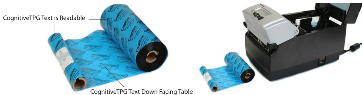
Imagen 2-23. Preparación de la cinta antes de cargarla en la impresora
