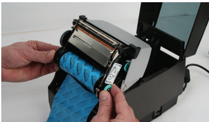
Imagen 2-29. Alinee el centro del rollo con las muescas en el portabobinas de la cinta
