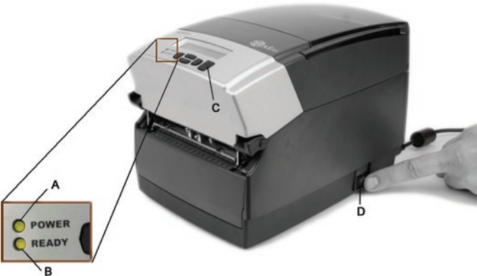
Imagen 2-17: Encendiendo la impresora C Series
