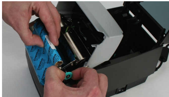
Imagen 2-33. Tirar de la ruedecilla elevadora para insertar el rollo elevador
