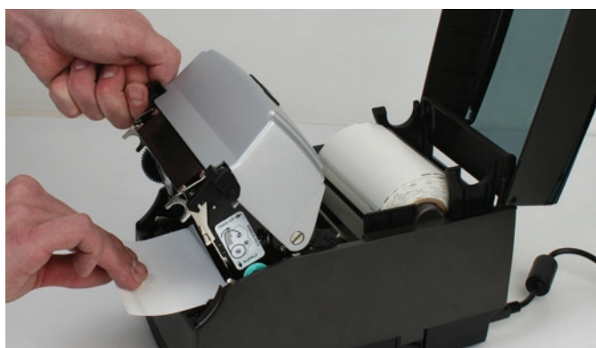
Imagen 2-49. Adelantar el material tres o cuatro pulgadas y luego centrar en el rodillo
