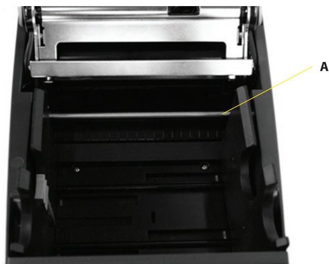
Imagen 2-4. C Series: vista superior de la guía del material desde la parte posterior de la impresora
