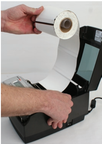
Imagen 2-43a. La cara de impresión debe estar hacia arriba para materiales de bobinado hacia dentro
