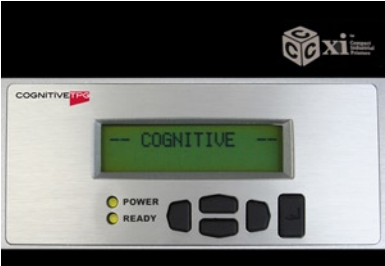
Imagen 2-18: Pantalla LCD en impresora CXI cuando la impresora está encendida
