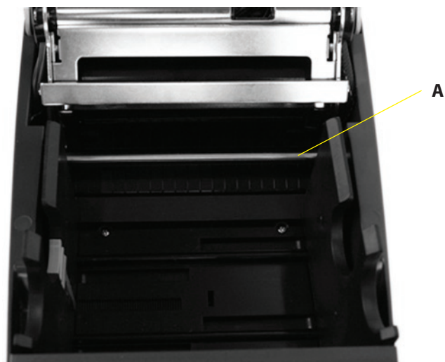
Imagen 2-42. Vista superior trasera de la guía para material de la impresora C Series
