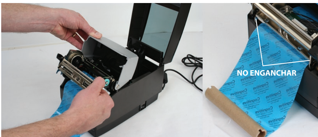
Imagen 2-31. Separar y bajar el mecanismo del cabezal de la interfaz del usuario sin engancharlo
