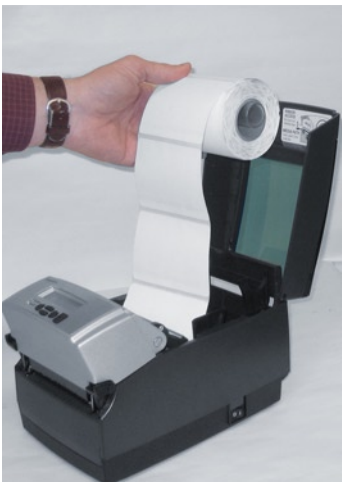
Imagen 2-43b. La cara de impresión debe estar hacia arriba para materiales de bobinado hacia fuera
