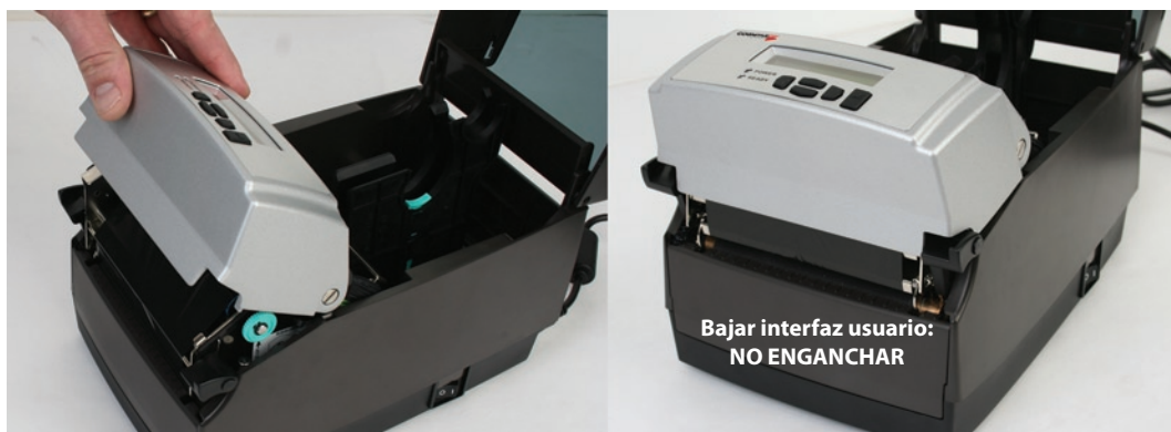
Imagen 2-36. Bajar la interfaz de usuario sin enganchar el mecanismo
