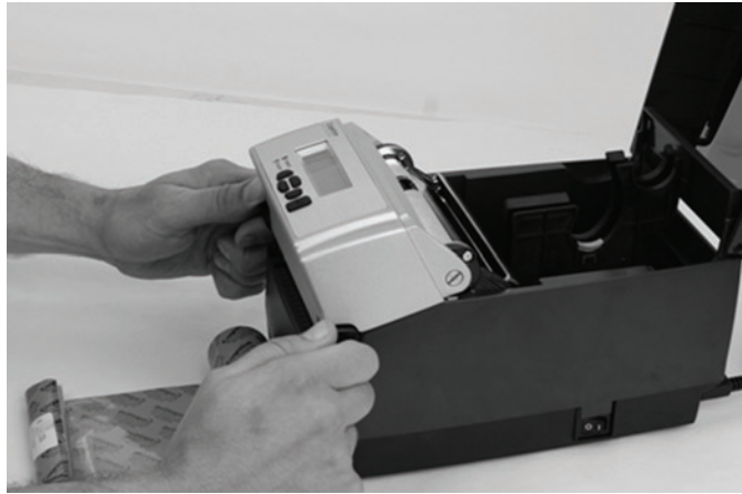
Imagen 2-24. Desenganchar el mecanismo del cabezal
