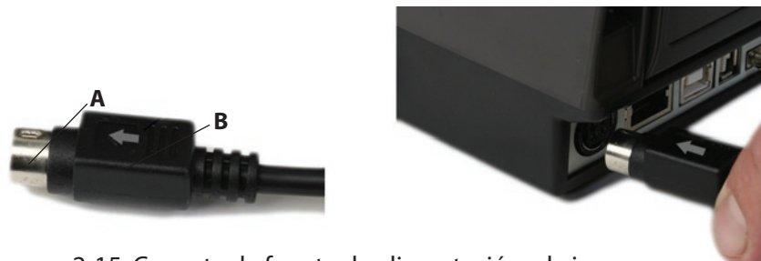
Imagen 2-15. Conectar la fuente de alimentación a la impresora
