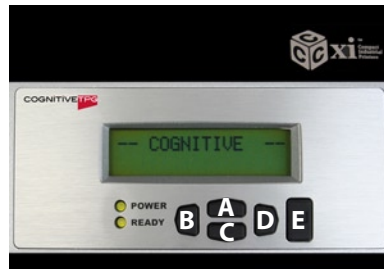
Imagen 2-10. Botones del menú de la interfaz del usuario en impresoras Cxi
