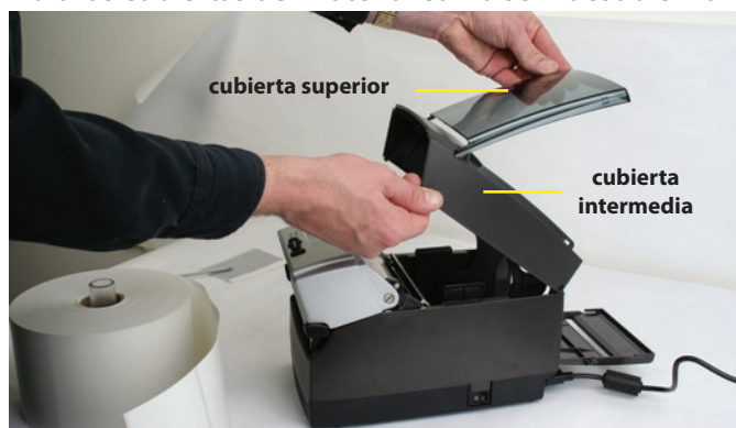
Imagen 2-54. Abrir cubiertas del material
