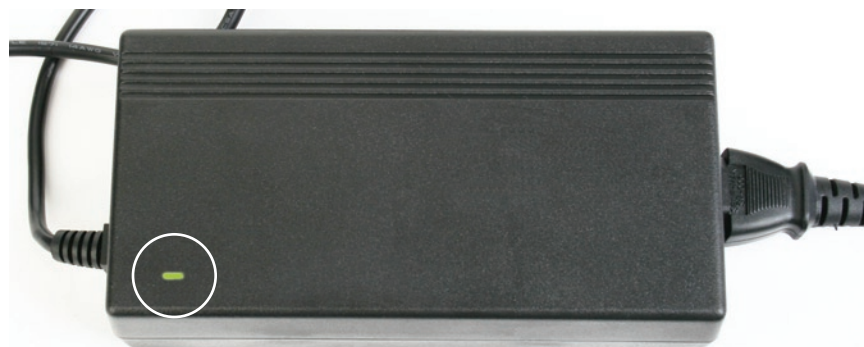
Figure 2-16. Luz verde en la fuente de alimentación
