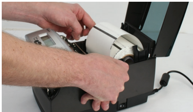
Imagen 2-45. Baje el rollo de material hasta las ranuras de las guías de material
