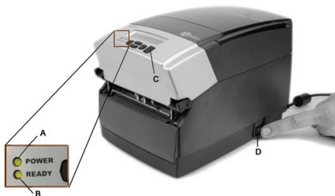
Imagen 2-12. Controles e indicadores de la impresora C Series
