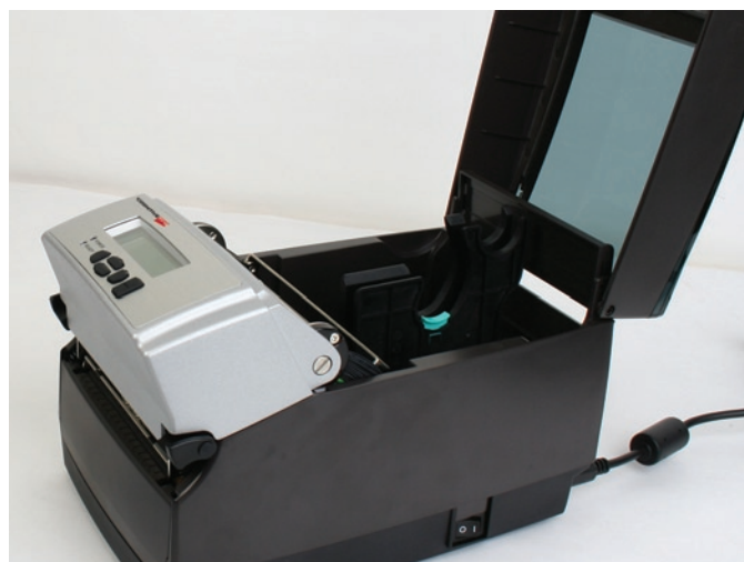
Imagen 2-20. Levantar la cubierta anti polvo
