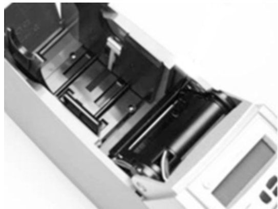
Imagen 2-3. C Series: vista interior lateral de la barra de material
