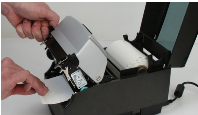
Figure 2-49. Traction sur le support sur trois ou quatre pouces puis centrage sur le cylindre
