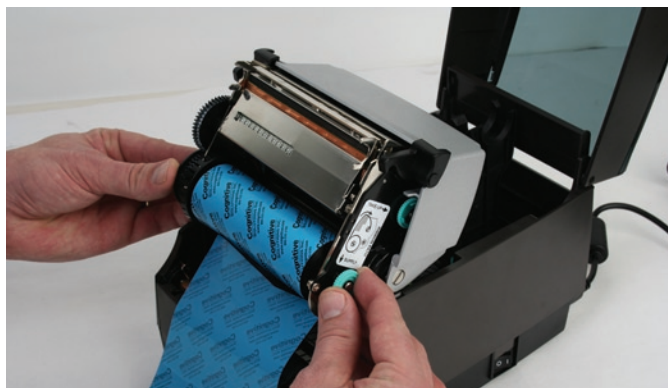
Figure 2-29. Alignement de la bobine d'alimentation du ruban avec les encoches de l'axe du ruban.
