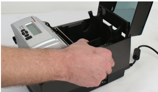
Figure 2-56. Écartement des guides de support
