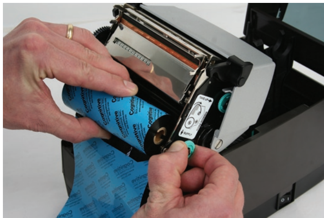
Figure 2-27. Alignement des encoches de la bobine d'alimentation du ruban avec les encoches de l'axe d'alimentation.
