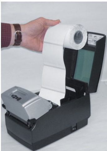
Figure 2-43b. La face à imprimer du support doit être orientée vers le haut pour les supports enroulés vers l’extérieur
