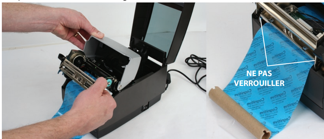
Figure 2-31. Séparation et descente du mécanisme de la tête d'impression à l'opposé de l'interface utilisateur, sans verrouillage du mécanisme.
