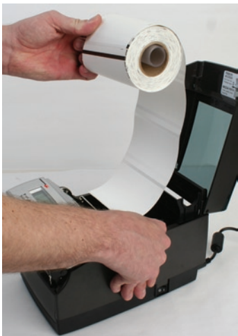
Figure 2-43a. La face à imprimer du support doit être orientée vers le haut pour les supports enroulés vers l’intérieur
