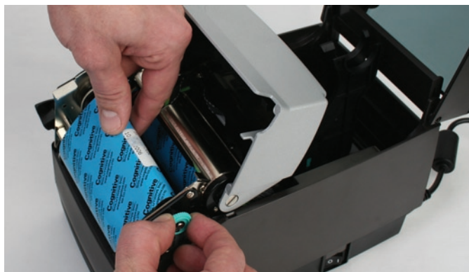
Figure 2-34. Pose de la bobine de collecte du ruban dans les encoches de l'axe de collecte
